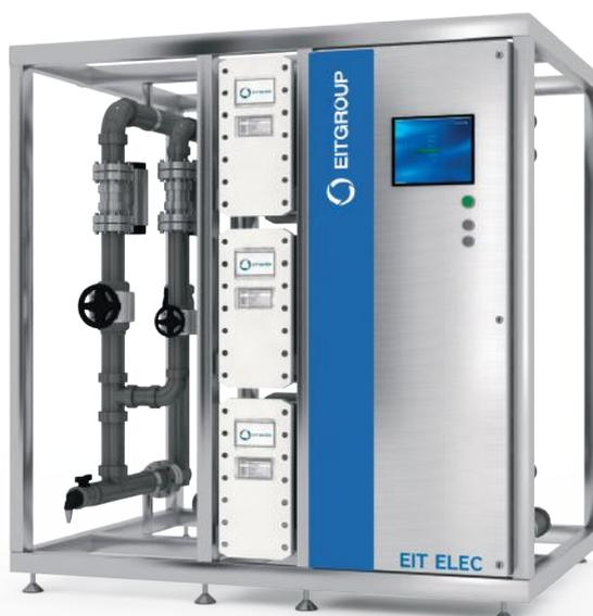
Los sistemas EDI sustituyen los lechos mixtos de resina para producir agua desionizada. A diferencia de la resina mixta, la electrodeionización continua no requiere paradas para sustituir las resinas o para regenerar usando químicos. Debido a esto, la electrodeionización (EDI) reduce al mínimo los trastornos de la calidad del agua y minimiza los costos de operación.
